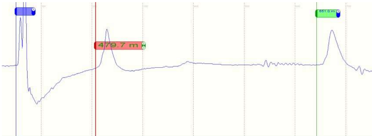
Figura 4 – Gráfico TDR com a localização da descarga
