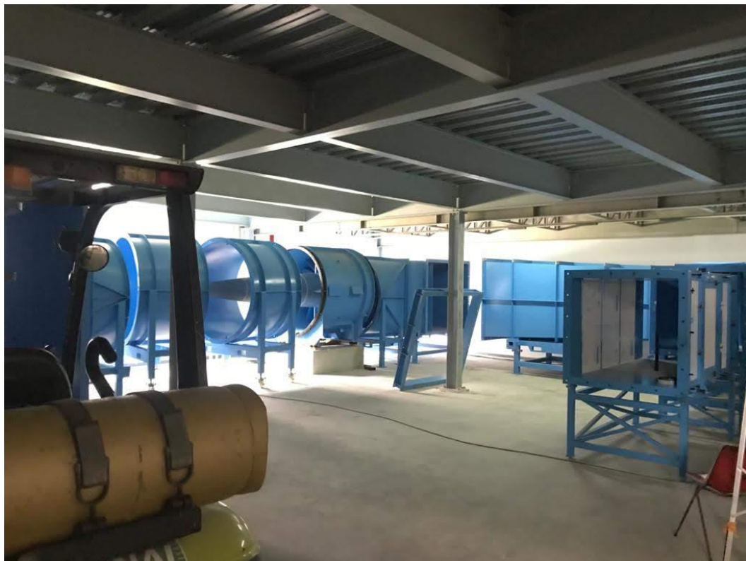
Figura 6 – Registro da montagem do túnel de vento nas instalações do ISI-ER.
