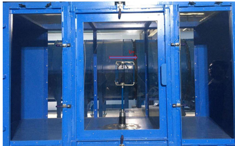
Figura 8 – Anemômetro ultrassônico instalado na seção de testes para realização das avaliações da qualidade do escoamento.
