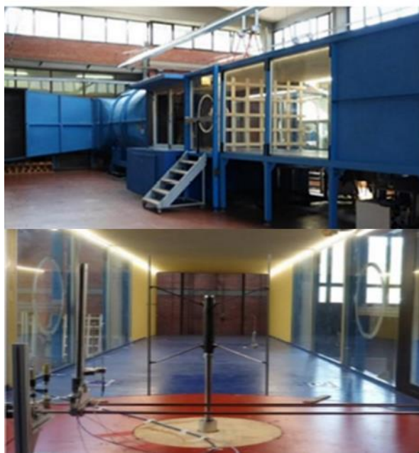
Figura 3: Desenvolvimento de APP (Aerogerador de Pequeno Porte) em túnel de vento (Francesco Balduzzi et. al., 2020).
