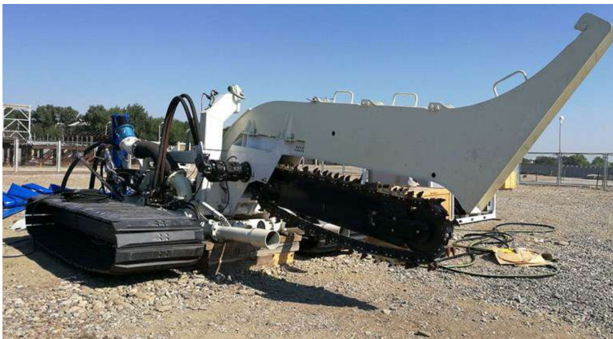
Figura 3.6 Valetadeira/ máquina de instalar cabos.
