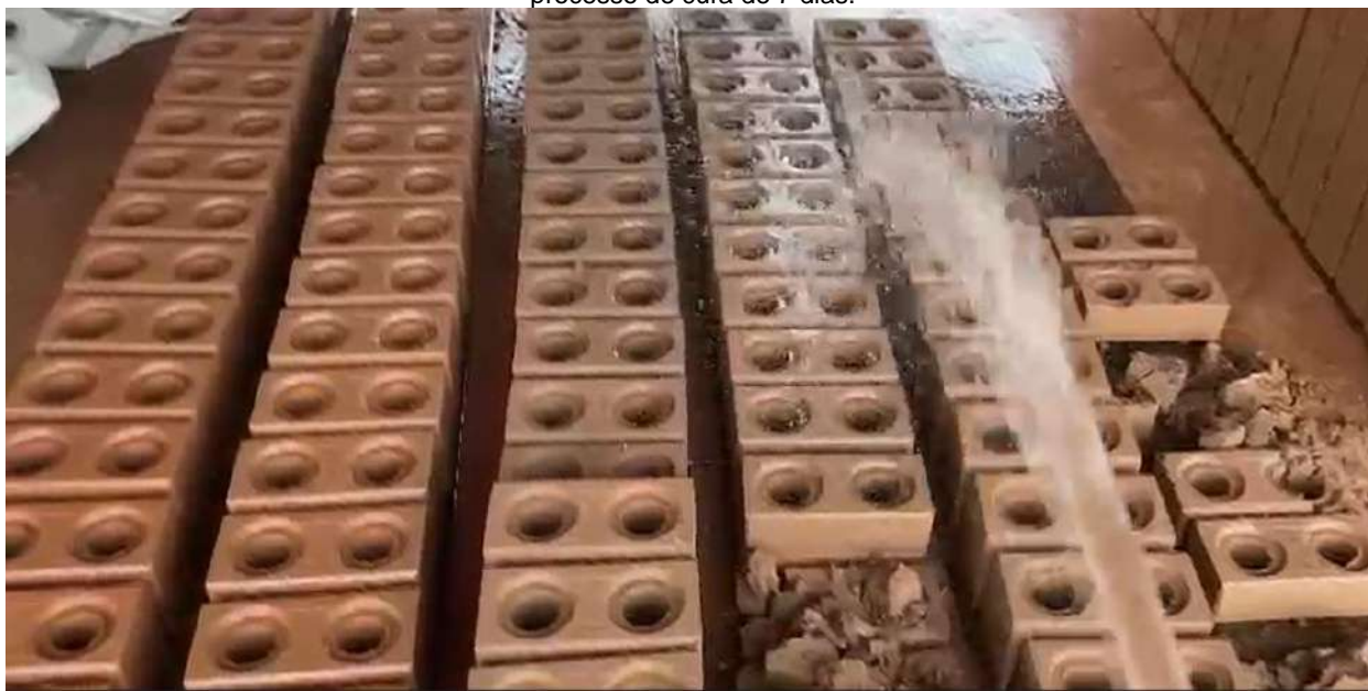
Figura 5. Tijolos ecológicos produzidos com adição do PET eólico em diferentes formulações, sendo molhados no processo de cura de 7 dias.
