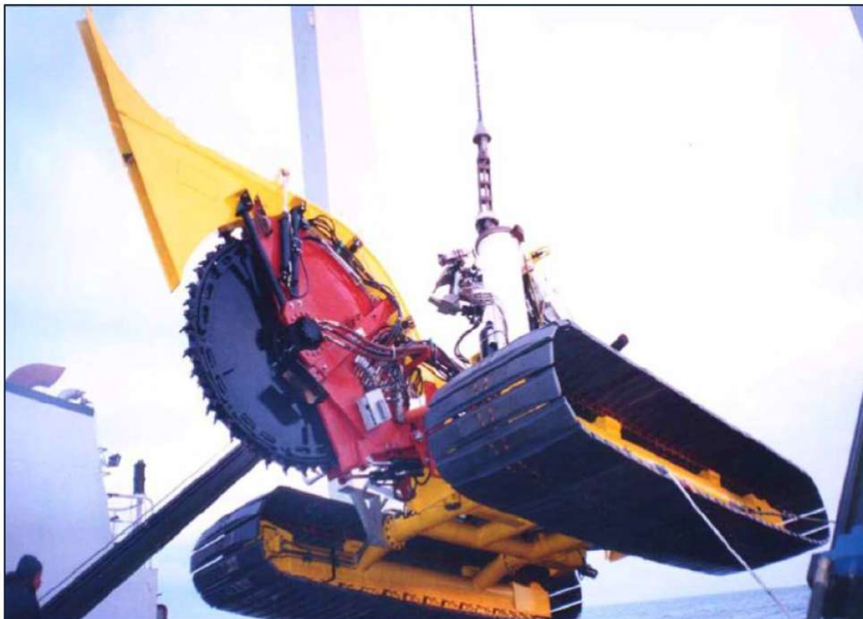
Figura 3.5: Valetadeira com serra cortadora de rocha.
