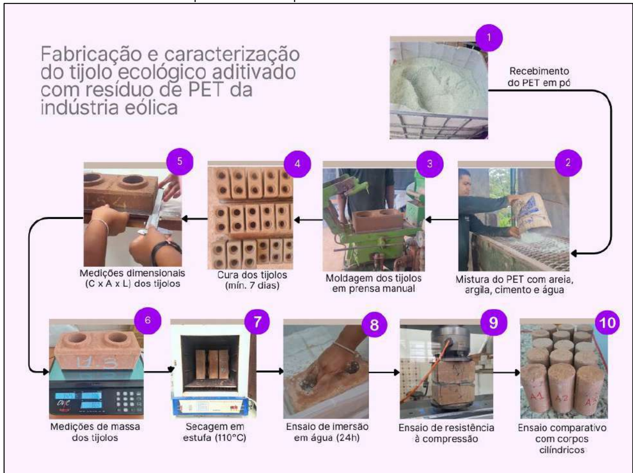
Figura 4: Fluxograma do processo utilizado neste trabalho para fabricação e caracterização tijolos ecológicos aditivados com resíduo de PET em pó da indústria de pás eólicas.
