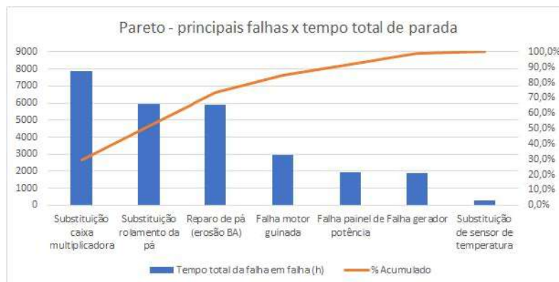
Figura 4. Princípio de Pareto para principais falhas nos aerogeradores
