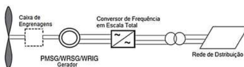
Figura 2 - Turbina eólica de velocidade variável completa com conversor de frequência em escala real TIPO D
