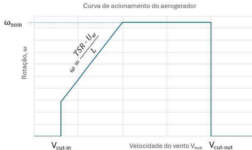
Figura 5 - Curva de acionamento do aerogerador
