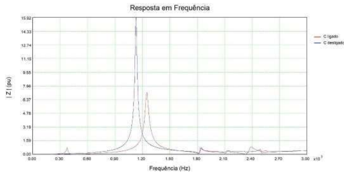
Figura 6 - Resposta em frequência do PAC com e sem banco de capacitores Fonte: Autoria própria (2023)
