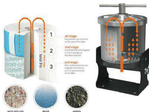
Figura 6 – Representação do funcionamento de um filtro offline.
