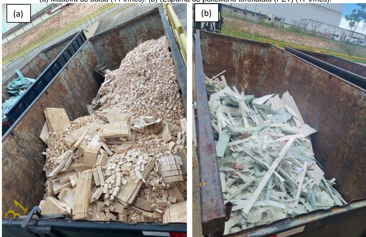
Figura 1. Resíduo de núcleo estrutural de pás eólicas gerados em uma fábrica de kits eólicos em Pernambuco: (a) Madeira de balsa (11 t/mês). (b) Espuma de polietileno tereftalato (PET) (17 t/mês).
