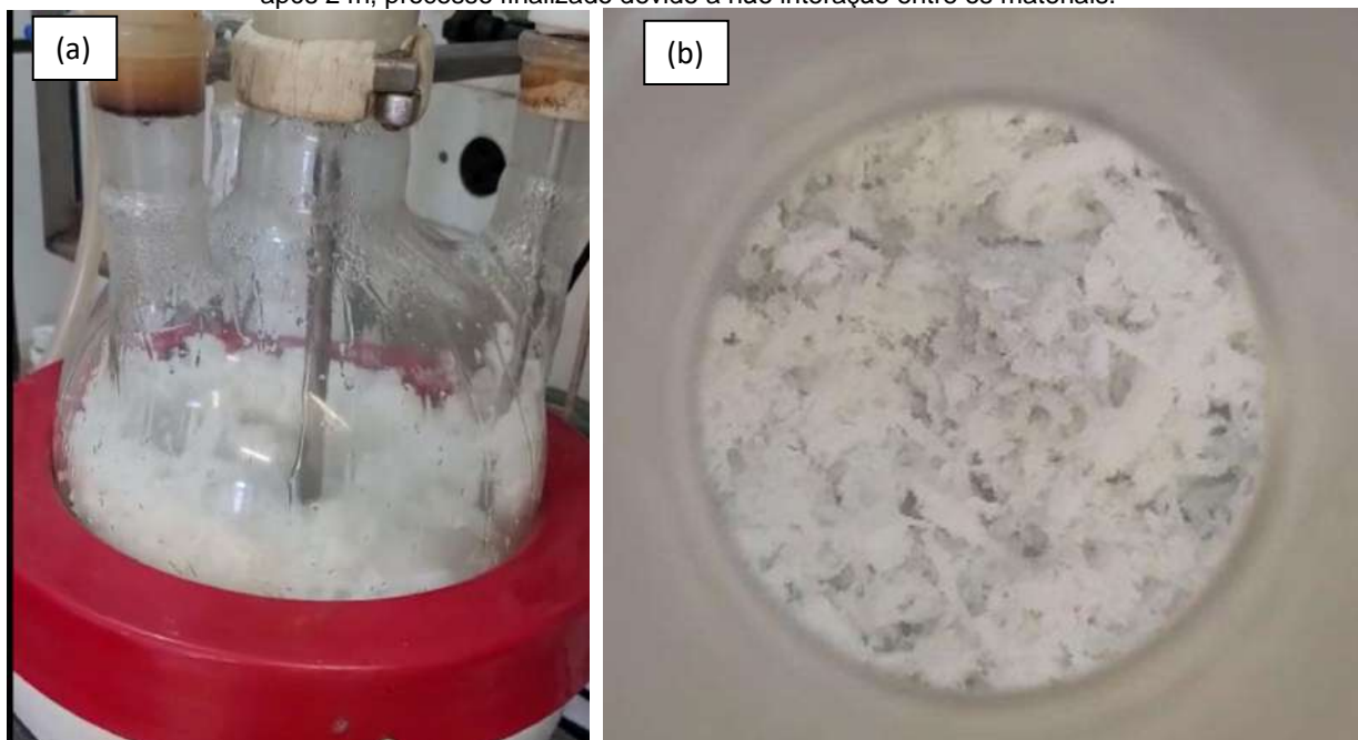
Figura 5. (a) Teste de compatibilidade química de resíduo de espuma de PET eólico em propilenoglicol. (b) Mistura após 24h, processo finalizado devido a não interação entre os materiais.
